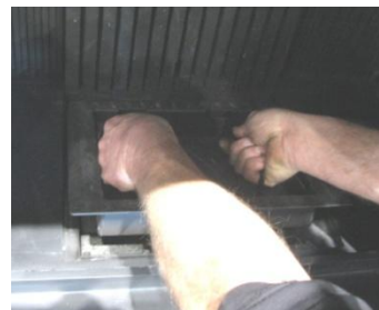
Maintenant le tiroir à cendres est visible. Soulevez le tiroir à cendres à l'avant et tirez-le ensuite vers le haut. Pour remettre le cendrier, il faut d'abord glisser l'arrière sous la languette avant de le remettre sur les supports.
